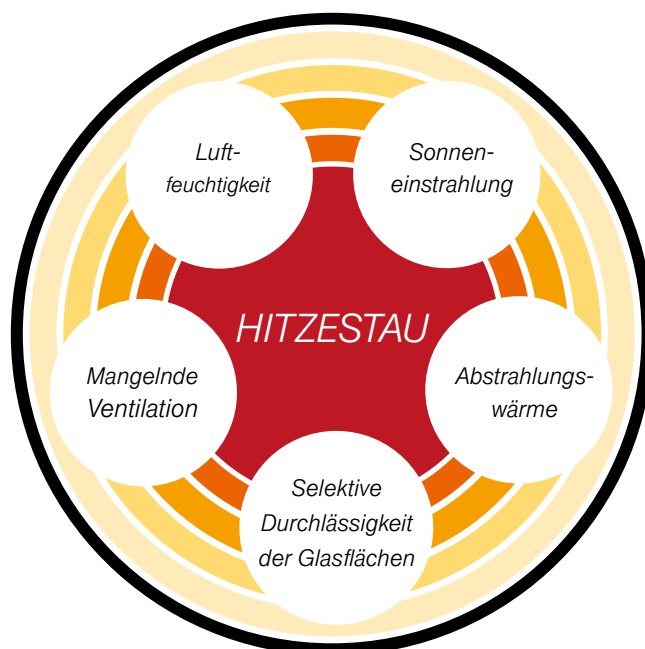
Abb. 1 Faktoren, die maßgeblich an einem rapiden Temperaturanstieg im Fahrzeuginneren beteiligt sind.
